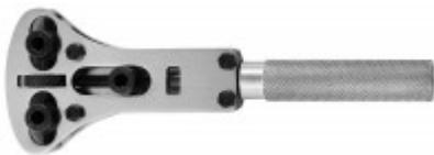
Der Gehäuseöffner eignet sich zum Öffnen von geschraubten Gehäuseböden, die am äußeren Rand in gleichmäßigen Abständen kleine Kerben eingearbeitet haben. Die separat verstellbaren Spannbacken lassen sich dort einsetzen um den Gehäuseboden bequem zu öffnen.
